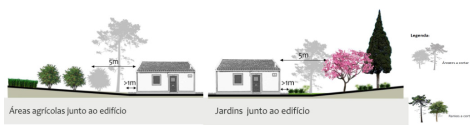
Figura 16- Esquema demonstrativo da gestão de combustível em FGC envolventes de edifícios situados em espaços agrícolas e jardins (adaptado de www.icnf.pt )
